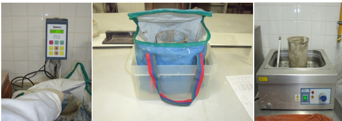
Figura 3.8 – Aparato criado para simular a temperatura ambiente de 5 ou 40°C. Da esquerda para a direita: Termómetro digital, saco térmico e banho-maria.
