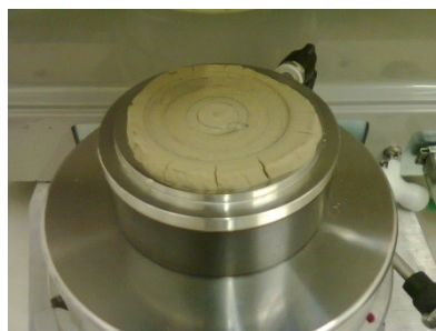
Figura 4.13 – Efeito de escorregamento do prato visível na superfície da amostra.
