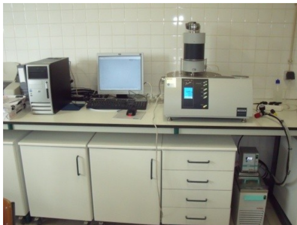
Figura 3.9 – TG-DTA/DSC STA 449 F3 Jupiter da Netzsch-Gerätebau GmbH.
