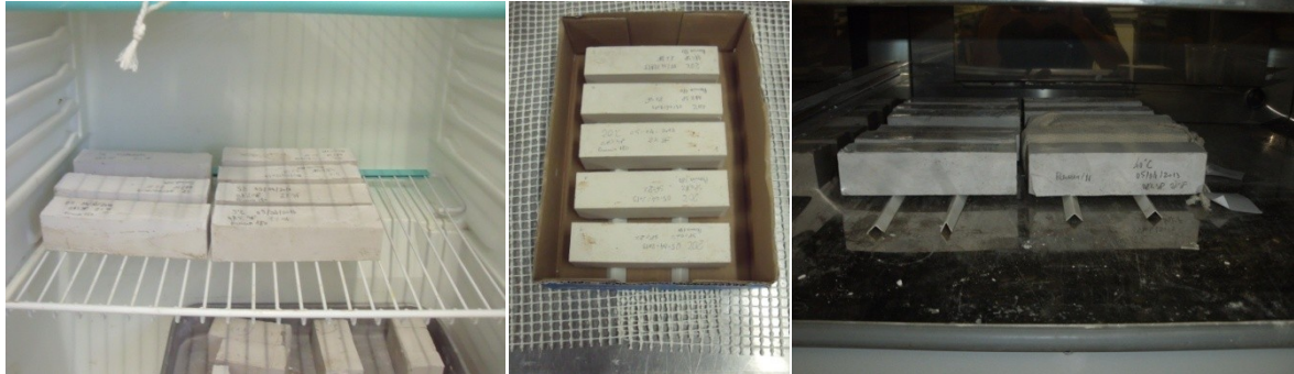
Figura 3.13 – Presa e endurecimento dos provetes a 5°C (esquerda), 20°C (centro) e 40°C (direita).
