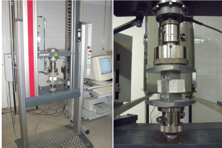
Figura 3.14 – Equipamento preparado para a realização dos ensaios de resistência à compressão.
