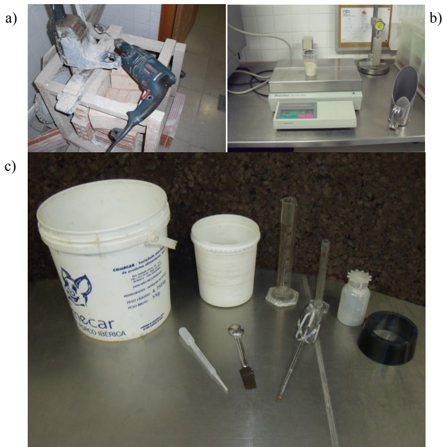
Figura 3.3 – Material utilizado no processo de amassadura da campanha experimental: a) berbequim marca Bosh; b) balança digital precisão 0,1g; c) material diverso, incluindo copos de plástico para a amassadura, provetas e misturador pequeno.
