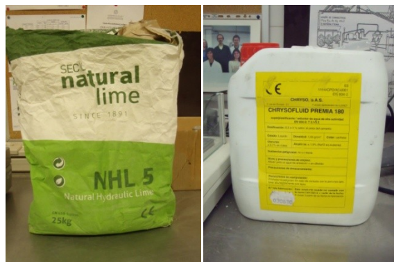
Figura 3.2 – Matérias-primas utilizadas no fabrico das caldas. Da esquerda para a direita: Cal NHL5, recipiente de plástico com o superplastificante.
