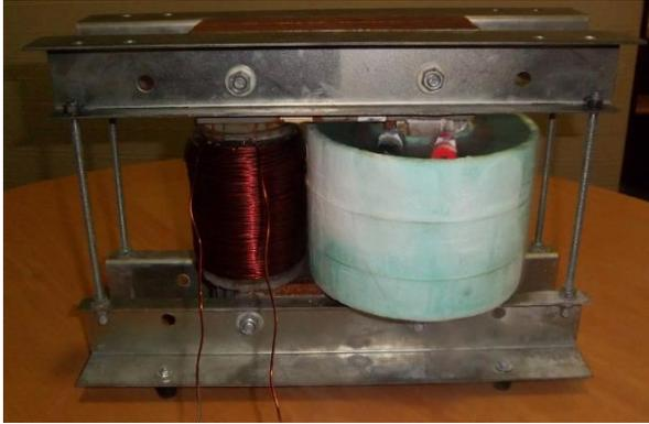
a) Transformador com secundário em fita supercondutora
