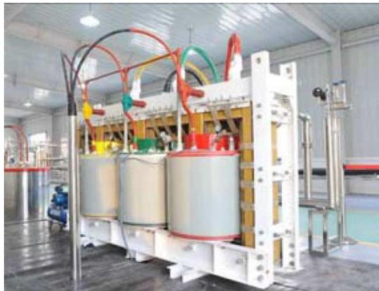
**Figura 2.3 - Transformador trifásico de núcleo amorfo supercondutor de 630 kVA (Xiao, L., et al., 2012).**
