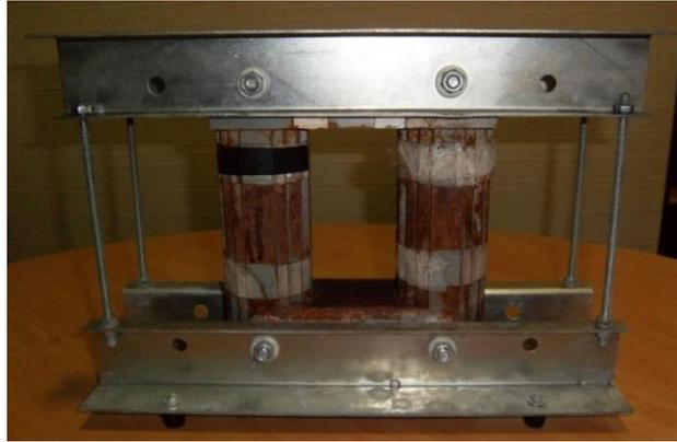
**Figura 5.2 - Núcleo ferromagnético**
