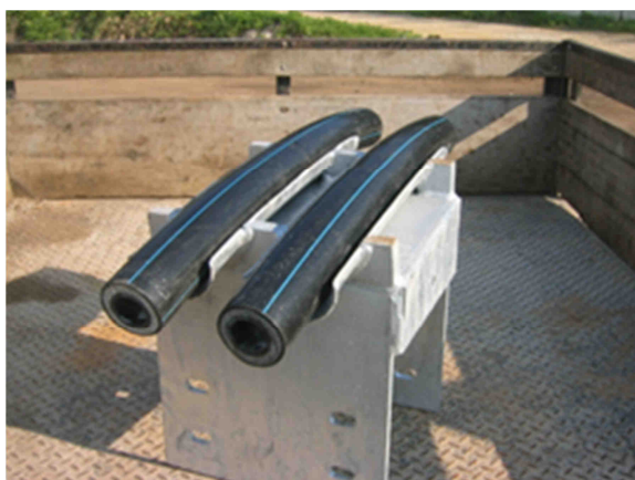
Figura 3.22 – Sela de desvio.
