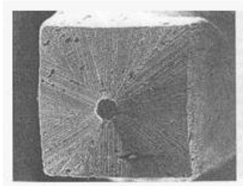
a) Macrografia da secção transversal do instrumento tipo K;
