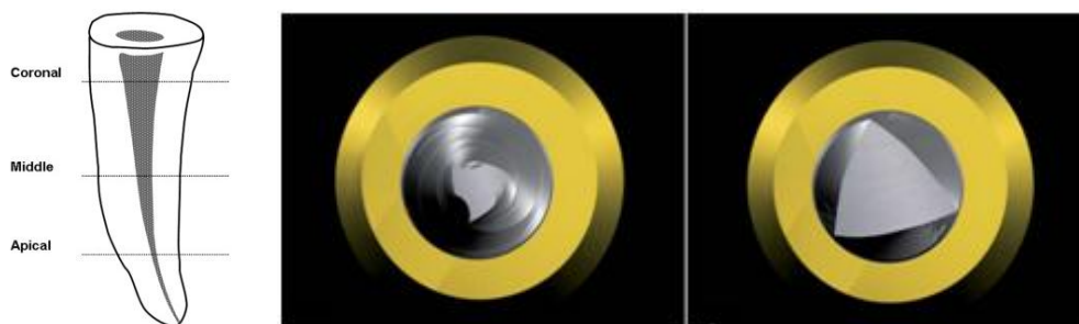
Figura 3.4 - caracterização das zonas do canal (lado esquerdo). Secção apical (ao centro) e secção coronal (lado direito) do instrumento WaveOne Primary TM [22].
