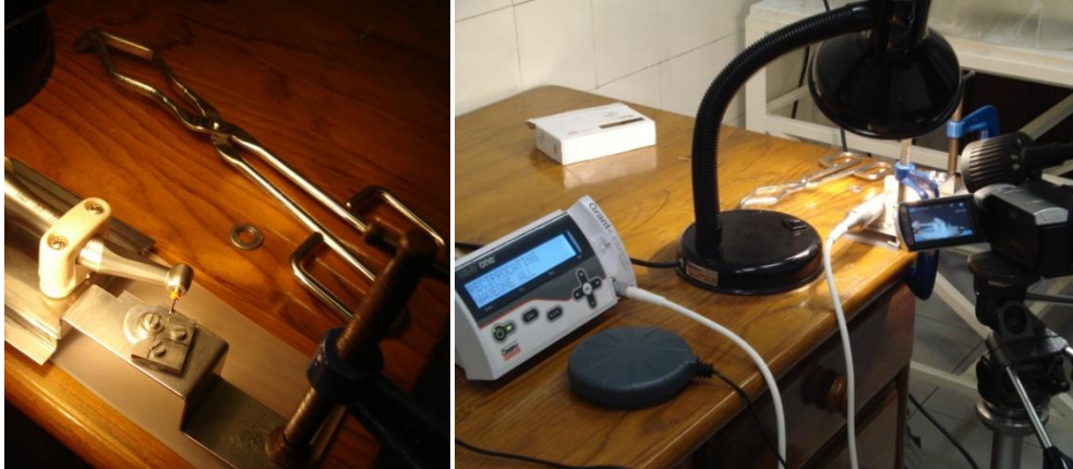
Figura 4.4 - Montagem experimental com micromotor, na programação WAVEONE ALL , com a máquina de filmar à direita.
