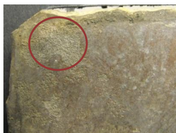
Figura 44 – Fragmento 6: à esquerda, corrosão sob a forma de picado, visto ao microscópio óptico, à direita, espectro EDXRF.
