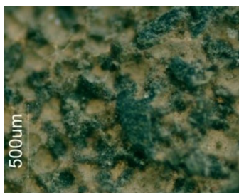
Figura 44 – Fragmento 6: à esquerda, corrosão sob a forma de picado, visto ao microscópio óptico, à direita, espectro EDXRF.
