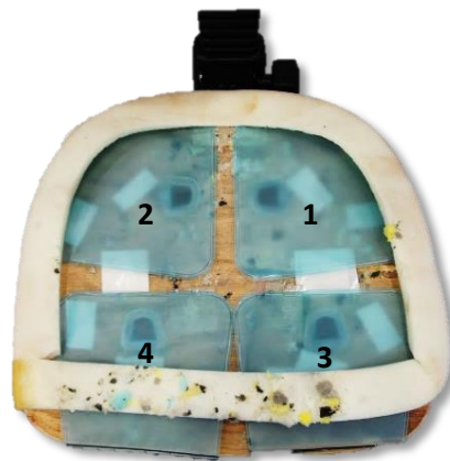
Figura 4.2 - Distribuição das bolsas de ar no assento da cadeira. 1-BL; 2-BR; 3-FL; 4-FR [2].
