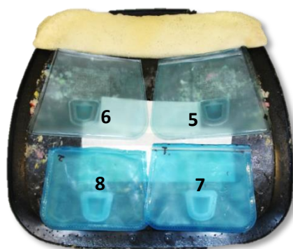
Figura 4.3 - Distribuição das bolsas de ar nas costas da cadeira. 5-UL; 6-UR; 7-LL; 8-LR [2].
