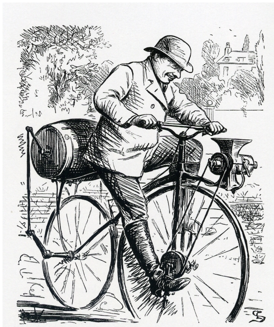
Figura 2.2 – A Bicicleta de Michaux, com as suas rodas assimétricas e os pedais acoplados à roda dianteira directriz. Fonte: Beeley, A History of Bicycles , 22.
