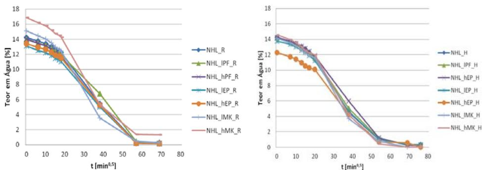
Figura 3 – Curvas de evaporação das argamassas
