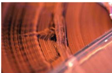
Figura 8. Defeito no enrolamento da fita: Cinching (fita apertada na cilha).
