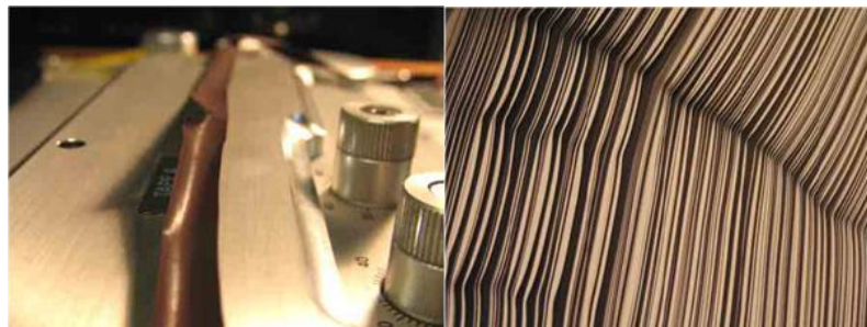
Figura 5. Exemplos de deformações em fitas de acetato 38 .
