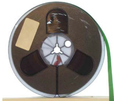
Figura 9. Exemplo de problema na fita magnética: windowing e popped strands .
