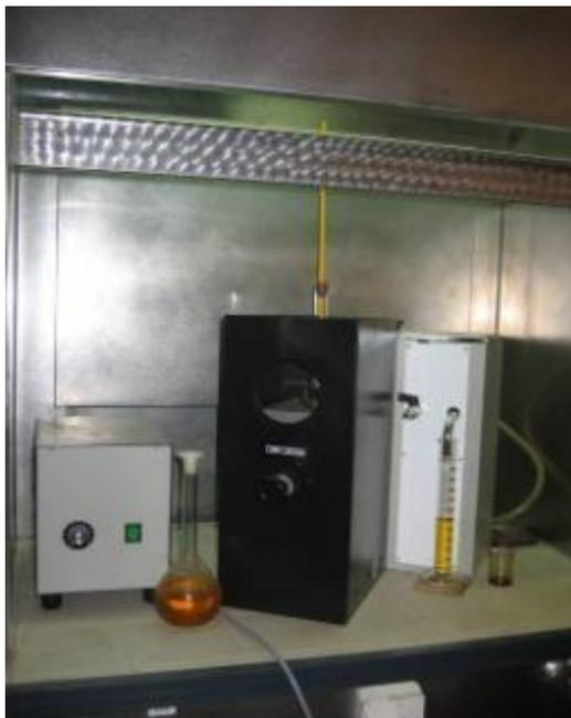
**Figura 3.9: Destilador utilizado na separação do líquido recolhido em três frações.**
