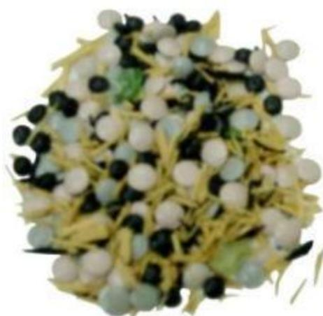
**Figura 3.2: Exemplo de uma mistura utilizada nos ensaios de pirólise: 10% de pinho, 10% de pneus e 80% de plásticos (56% PE, 17% PS e 27% de PP).**
