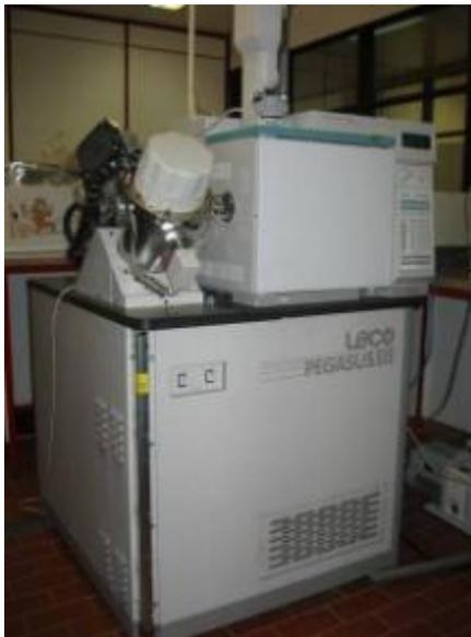
**Figura 3.11: Cromatógrafo associado a espectrômetro de massa (GC/MS) utilizado na identificação de compostos nas amostras líquidas.**
