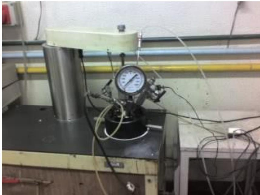
**Figura 3.3: Autoclave utilizada nos ensaios de pirólise.**
