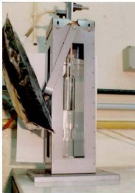
**Figura 3.7: Densímetro utilizado na medição da densidade dos produtos gasosos.**
