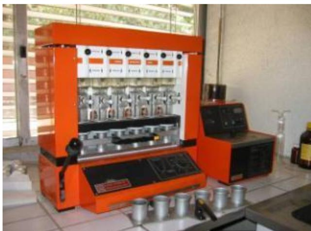
**Figura 3.10: Extrator de Soxhlet automático utilizado nas extrações dos sólidos.**
