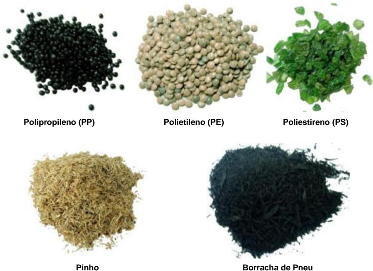
Figura 3.1: Aspecto da granulometria dos materiais utilizados.
