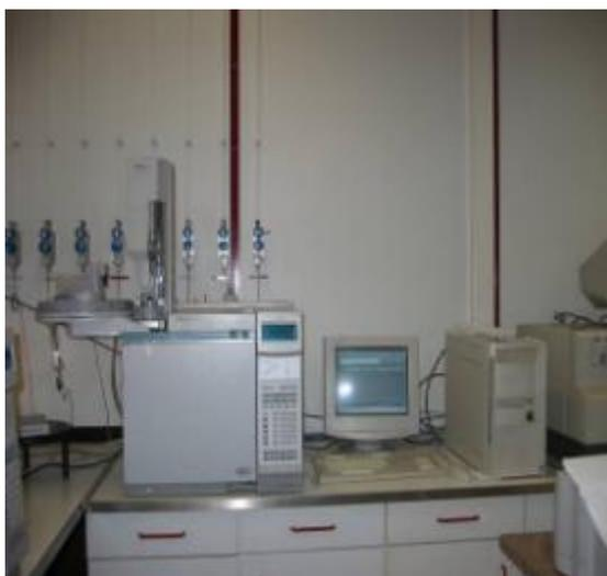
**Figura 3.12: Cromatógrafo utilizado na quantificação dos compostos nas amostras líquidas.**
