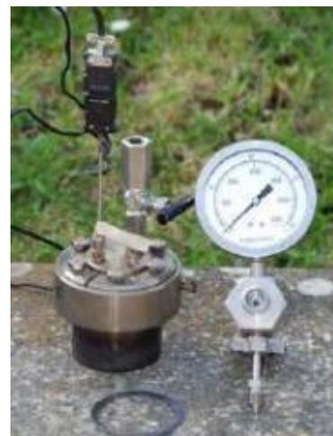
Figura 3.6: a) Pormenor do arrefecimento da autoclave com gelo. b) Autoclave com o termopar montado e a junta de grafite e o indicador de pressão em separado.
