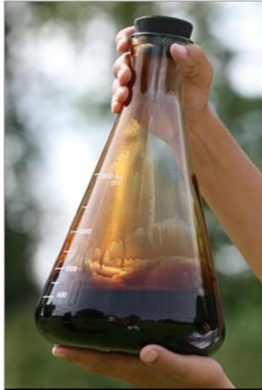
**Figura 2.22: Exemplo da fração líquida dos produtos da pirólise rápida de biomassa (bio-óleo).**
