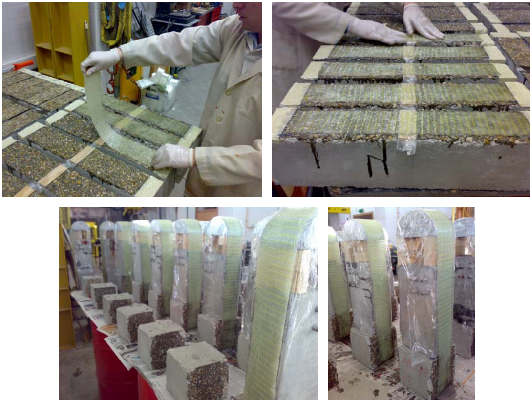
Figura 3.6: Aplicação do compósito de GFRP às peças de betão.
