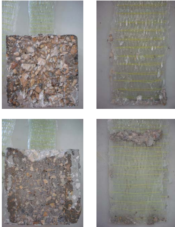
Figura 2.32: Superfícies de ruptura dos ensaios de corte com superfície de betão demasiado rugosa (em cima) e com superfície de betão mais plana (em baixo) [137].
