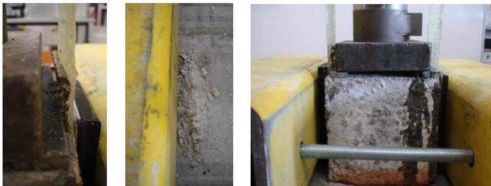
Figura 4.14: Pormenores dos ensaios com compressão lateral após a ruptura.
