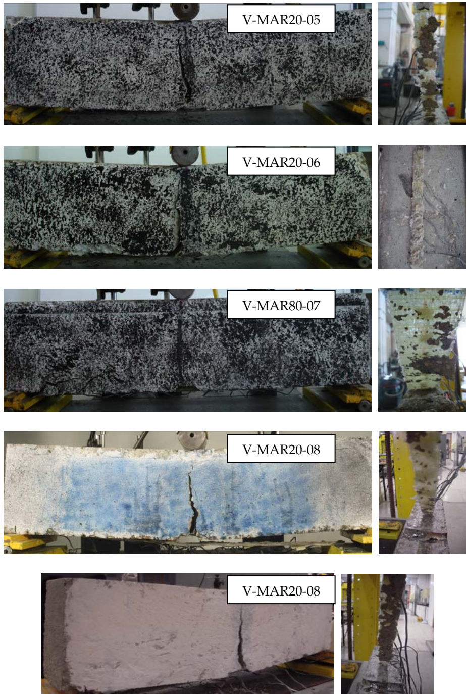
Figura C.19: Modos de ruptura das vigas submetidas a ciclos de marés - 10000 horas.
