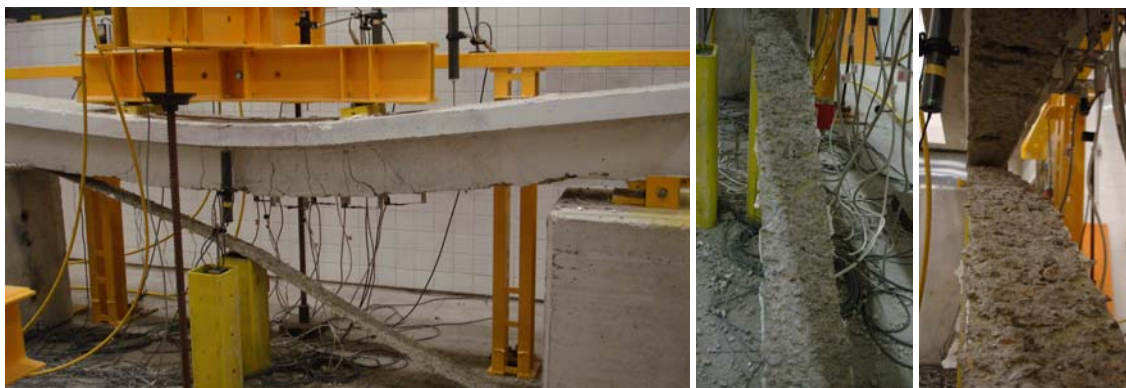
Figura 6.31: Modo ruptura no reforço de GFRP da viga sob carregamento cíclico.
