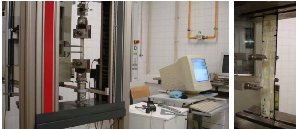
Figura 3.12: Máquina de tracção universal Zwick (à esquerda) e pormenor do modo de ruptura de um provete plano de GFRP (à direita).
