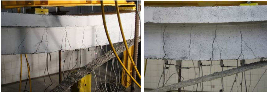
Figura 6.23: Fendilhação observada na viga sob carregamento monotónico após a descolagem do compósito de GFRP.
