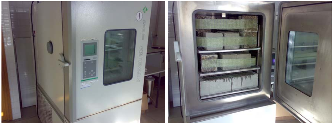
Figura 3.20: Câmara climática (à esquerda) e disposição inicial dos provetes numa das câmaras (à direita).
