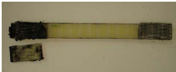
Figura 3.27: Modo de ruptura por descolamento dos tabs do provete plano GFRP-SM-09.
