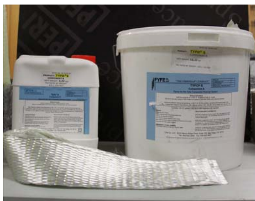
Figura 3.14: Resina e aspecto das fibras de vidro utilizadas na concepção dos provetes.
