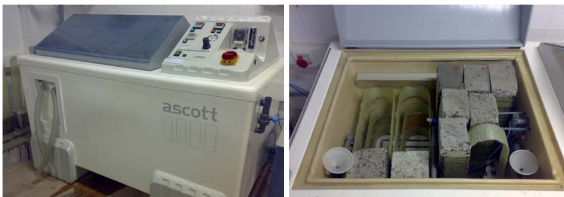
Figura 3.15: Câmara de nevoeiro salino (à esquerda) e disposição inicial dos provetes na câmara (à direita).
