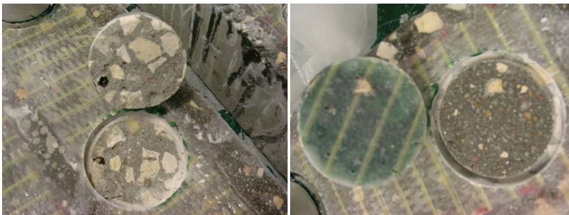
Figura 2.13: Ruptura coesiva pelo betão (à esquerda) e ruptura adesiva pela interface entre o adesivo e o betão (à direita) [18].
