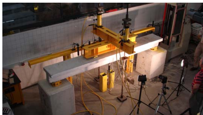
Figura 6.13: Panorama dos ensaios de flexão das vigas com secção transversal em T.
