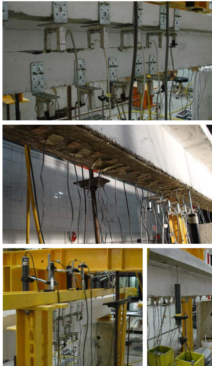
Figura 6.12: Pormenores da instrumentação utilizada.
