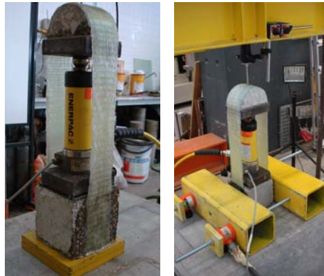
Figura 4.7: Sistema de ensaio de corte duplo adoptado: (i) sem tensão de compressão lateral (à esquerda; e (ii) com tensão de compressão lateral (à direita).
