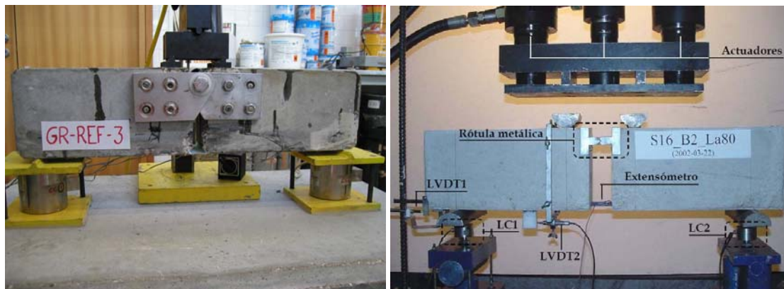
Figura 2.20: Viga com rótula metálica: (i) com recurso a 4 chapas metálicas (à esquerda) [18] e (ii) com recurso a peças metálicas em forma de “T” (à direita) [97].
