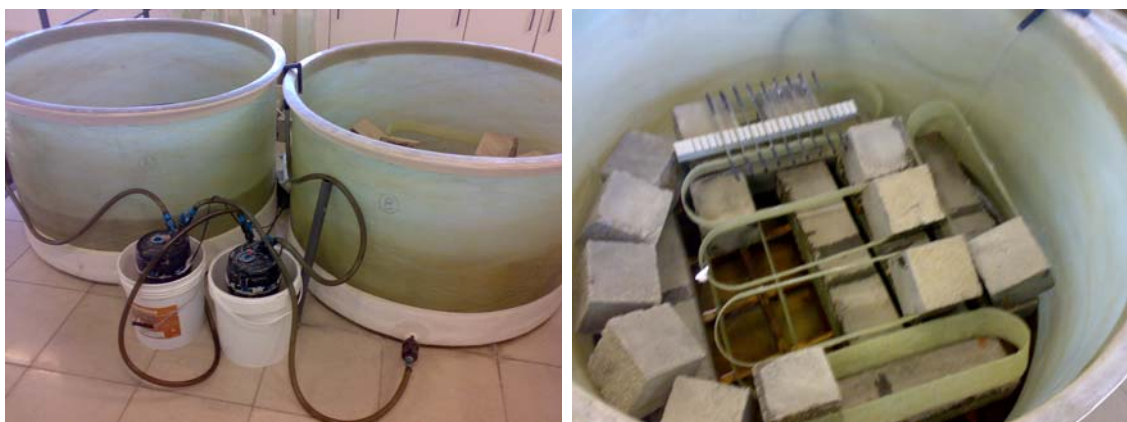
Figura 3.17: Tanques e sistema de bombas hidráulicas (à esquerda) e disposição inicial dos provetes num dos reservatórios (à direita).
