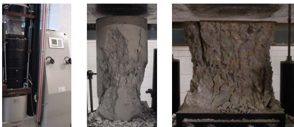
Figura 3.10: Prensa de compressão e pormenores dos modos de ruptura de um cilindro e de um cubo de betão.
