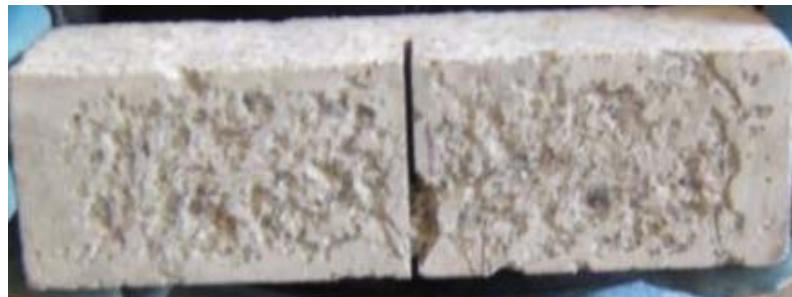
Figura 2.33: Aspecto final do provete rejeitado por Khalighi [95] com tratamento de superfície por intermédio de martelo pneumático.
