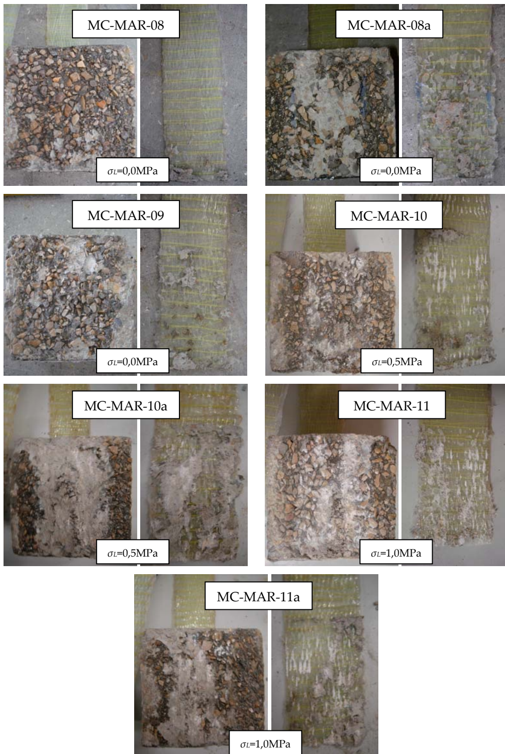
Figura C.6: Modos de ruptura dos provetes submetidos a ciclos de marés - 10000 horas.
