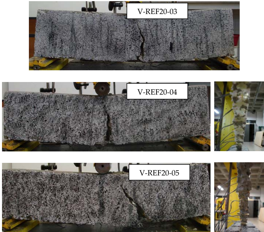
Figura C.15: Modos de ruptura das vigas de referência de secção rectangular exteriormente reforçadas com GFRP com 80mm de largura.
