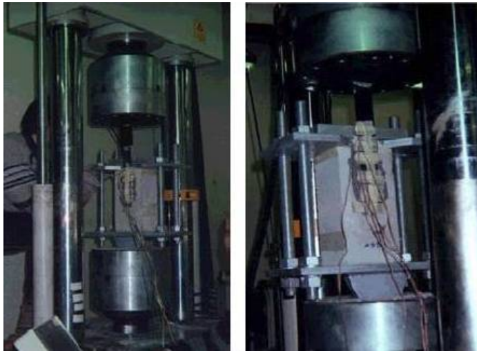
Figura 2.16: Ensaio de corte simples utilizado por Faella et al. [84].
