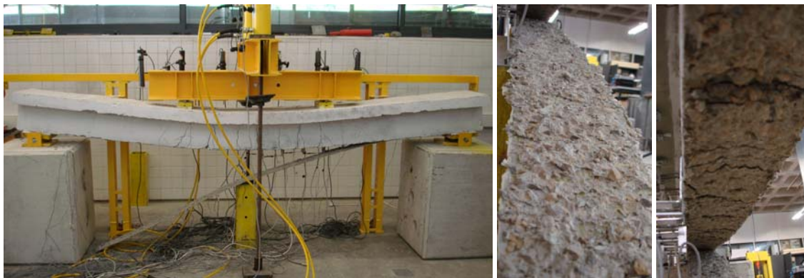
Figura 6.25: Modo ruptura no reforço de GFRP da viga sob carregamento monotónico.
