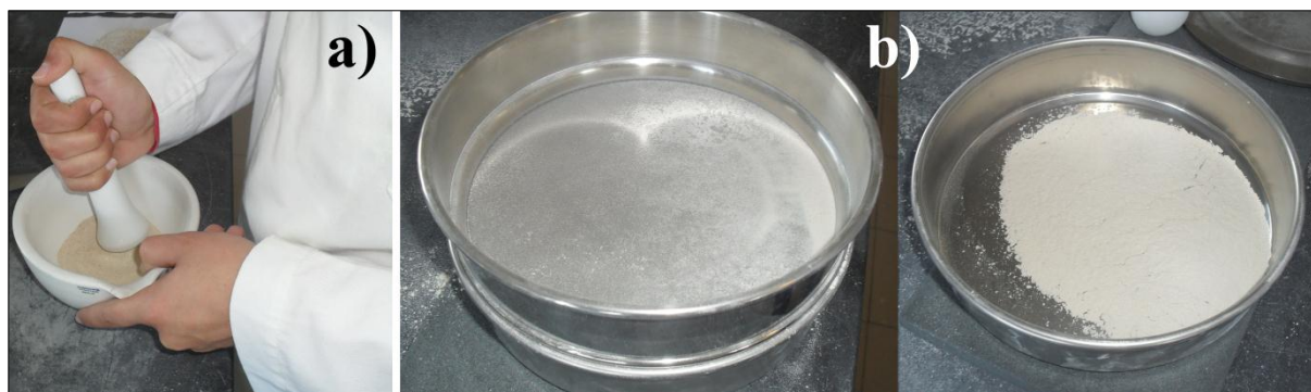
Figura 3.27 – Preparação da amostra para análise de termogravimetria
