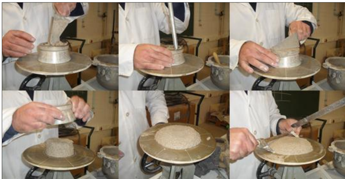
Figura 3.4 – Ensaio de consistência por espalhamento
