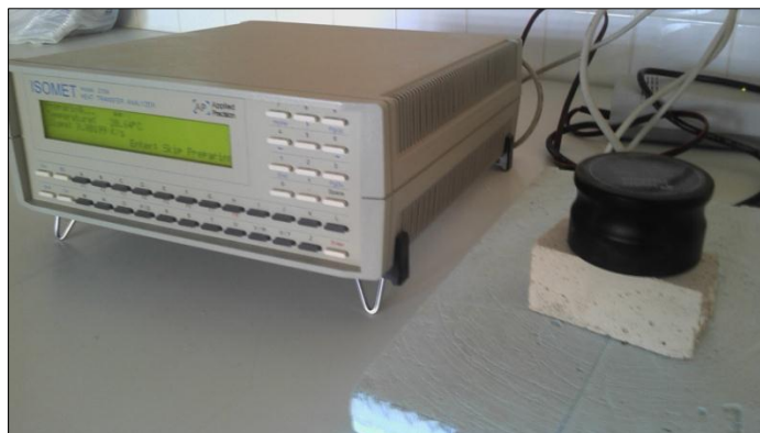
Figura 3.17 – Realização do ensaio de determinação aproximada da condutibilidade térmica
