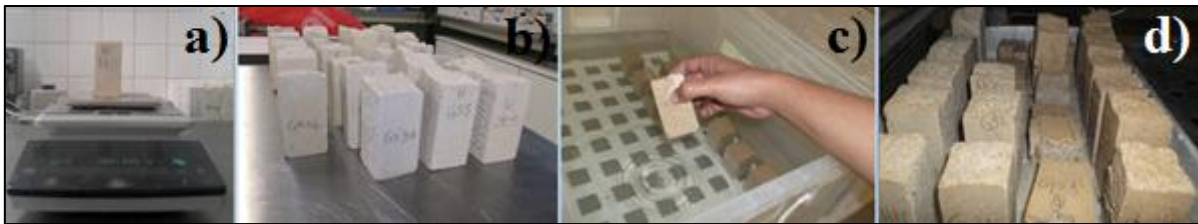
Figura 3.20 – Ciclos do ensaio de resistência aos sulfatos
