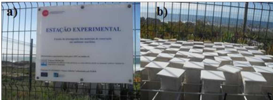
Figura 3.6 – Estação experimental do LNEC e provetes em exposição junto ao mar
