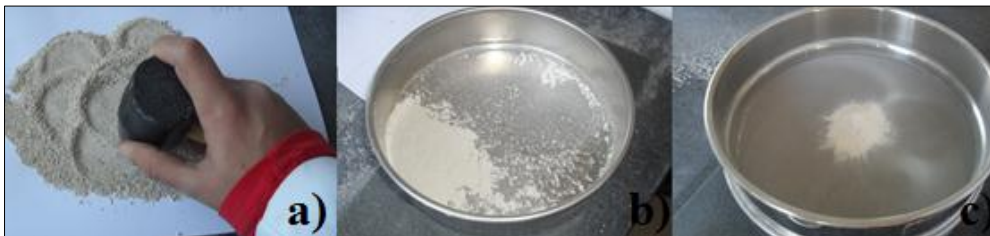
Figura 3.24 – Preparação da amostra para análise XRD.
