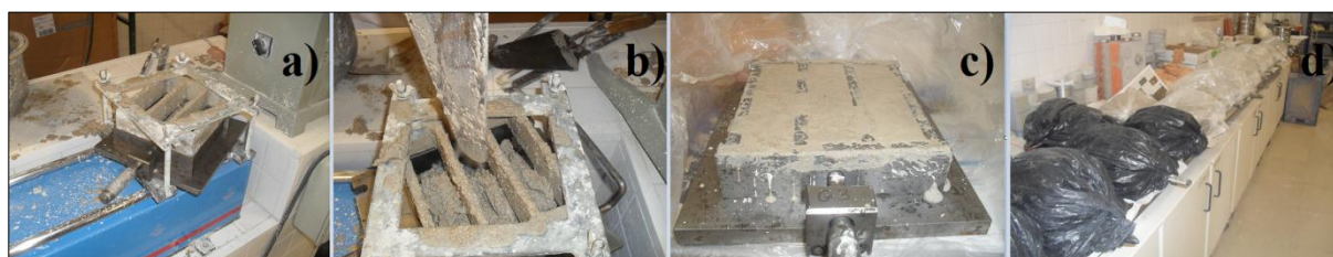
Figura 3.5 – Moldagem, compactação e nivelamento dos provetes e cura inicial dentro de saco de polietileno
