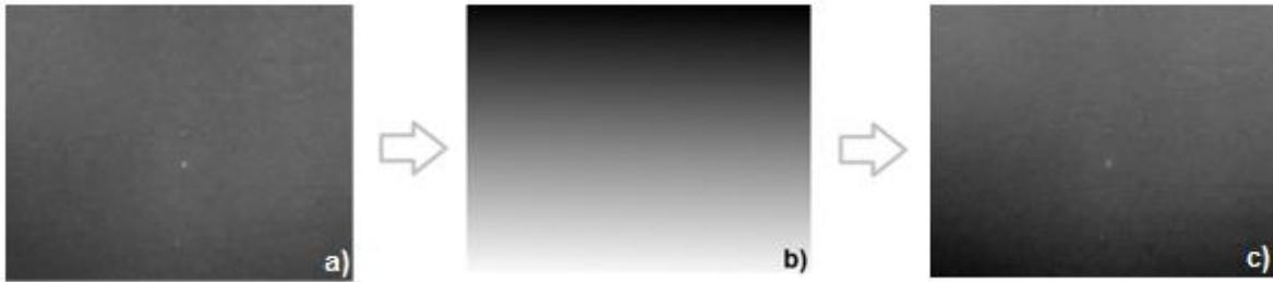
Figura 4.20: a) Componente verde da imagem; b) Plano; c) Imagem resultante da subtracção.
