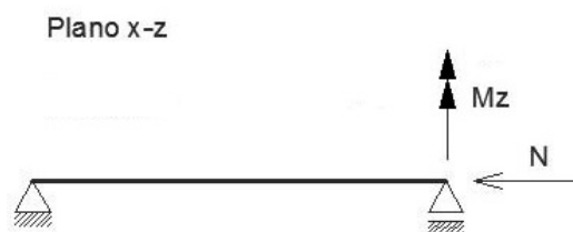
Figura 3.13: Geometria e carregamento das colunas-viga apoiadas-apoiadas - comportamento plano
