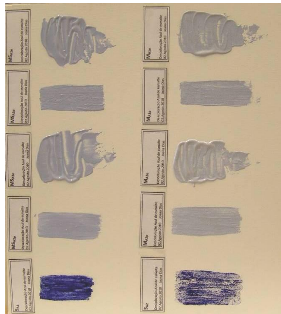
Figura 5 – Suporte de gesso após a aplicação das tintas à base de óleo
