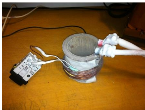
Figura 6.4: Bobina supercondutora com enrolamento auxiliar.
