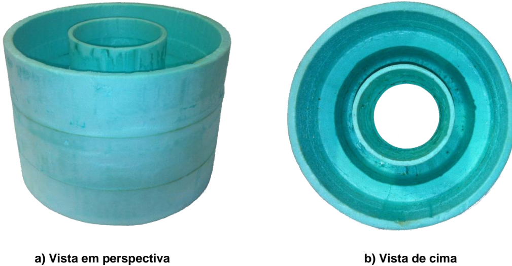
Figura 5.10: Crióstato feito em XPS fabricado pela máquina de fazer crióstatos.
