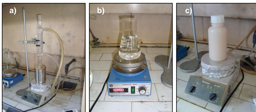
Fig. 5.10 - Ensaio de Chapelle: a) Montagem do ensaio; b) Solução de sacarose em agitação; c) Mistura das soluções de sacarose e de MK e CaO
