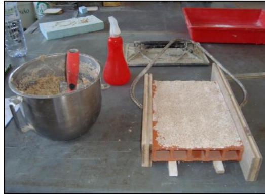
Fig. 4.12 - Molde do tijolo para aplicação da camada de argamassa
