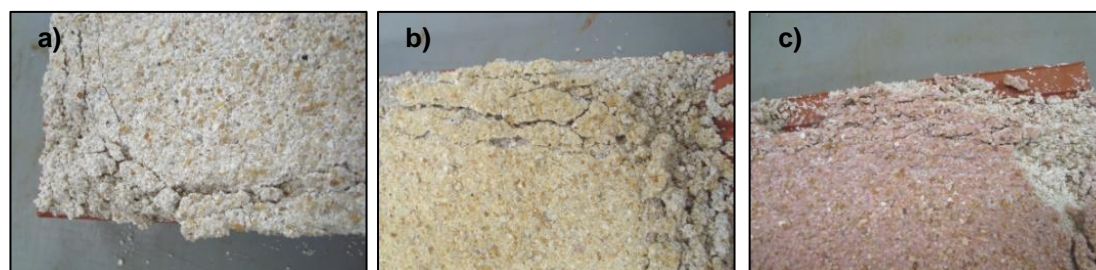
Fig. 7.12 – Fendilhação dos bordos laterais das camadas de argamassa: a) MK25% CC; b) MK25%+OA5%; c) MK25%+VB5%
