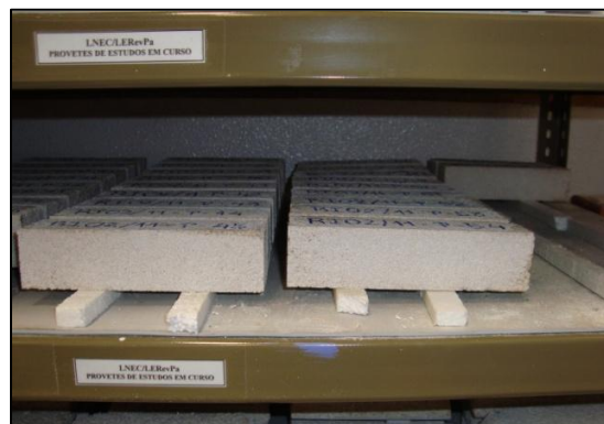
Fig. 4.10 - Provetes desmoldados e numerados em cura seca
