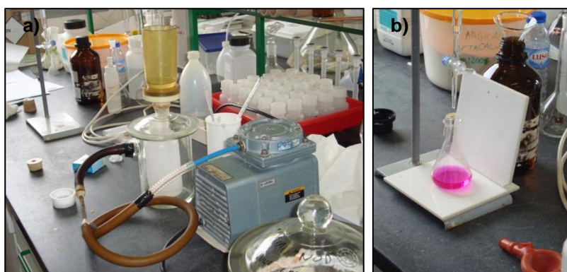
Fig. 5.11 - Ensaio de Chapelle: a) Filtragem; b) Titulação
