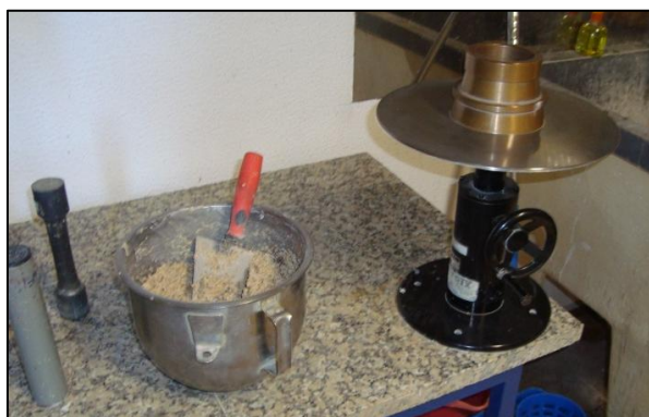
Fig. 4.3 - Mesa de espalhamento com molde tronco-cónico e argamassa a ensaiar
