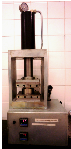
Figura 3.18: Prensa - prensagem do molde com filme e sal
