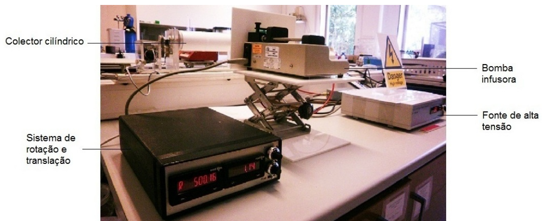
Figura 3.3: Sistema de electrofiação com colector cilíndrico rotatório
