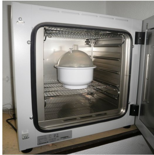
Figura 3.9: Forno com exsicador contendo as amostras e o cristalizador com solução de GTA
