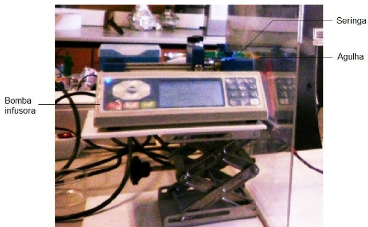
Figura 3.2: Pormenor do sistema de electrofiação com colector plano
