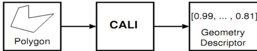
Figura 2.12: Obtenção de descritores a partir da geometria da imagem.
