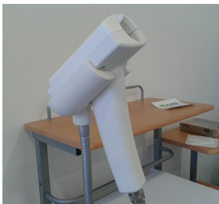
Figura 4.2: Imagem do espirômetro associado ao BreathSpec®
