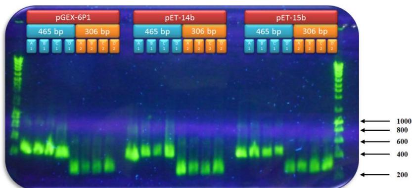
**Figura 25** – Análise dos fragmentos puros de *yps* para os ensaios com os vectores pGEX-6P1, pET-14b e pET-15b. A purificação foi feita com o *kit* QIAquick Gel Extraction Kit (QIAGEN), com um rendimento médio de  $\approx$  90 %.
