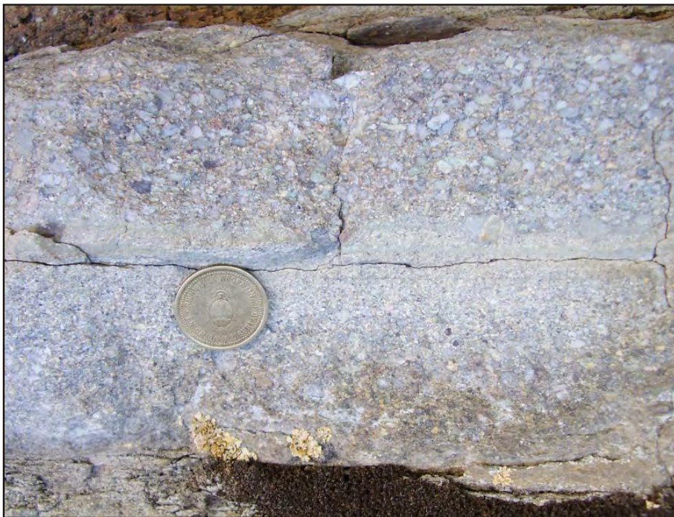
Figura 3.25. Facies epiclásticas de brechas masivas o gradadas (Brm) clasto-sostén. En el presente caso se muestran con gradación inversa.
