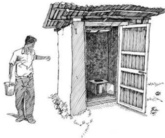
Figura 3.11 – Esquema de latrina de balde (Shaw, 2011).
