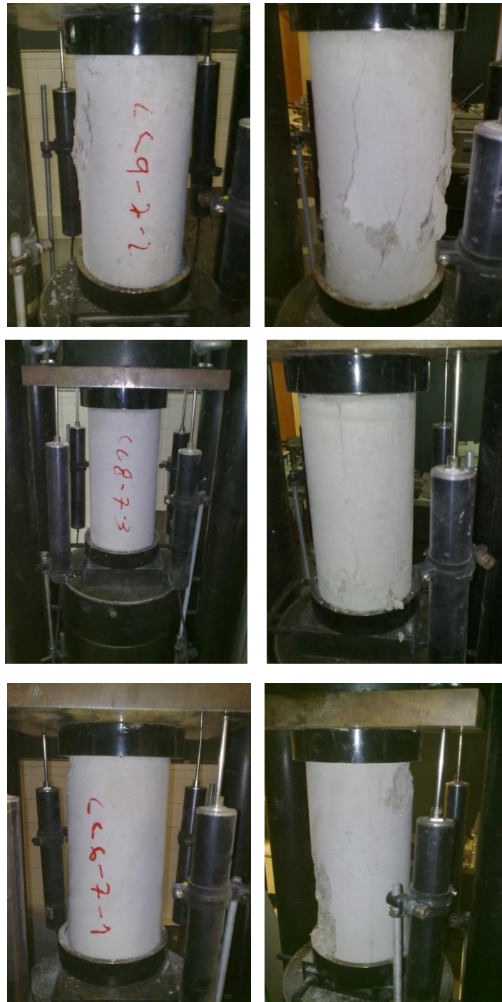
Figura 4.7 – Roturas satisfatórias obtidas em provetes cilíndricos
