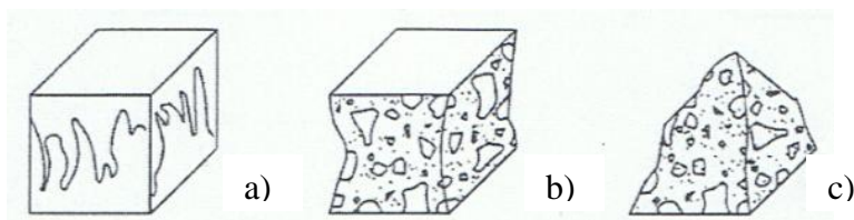
Figura 2.8 – Roturas satisfatórias de provetes cúbicos [26]
