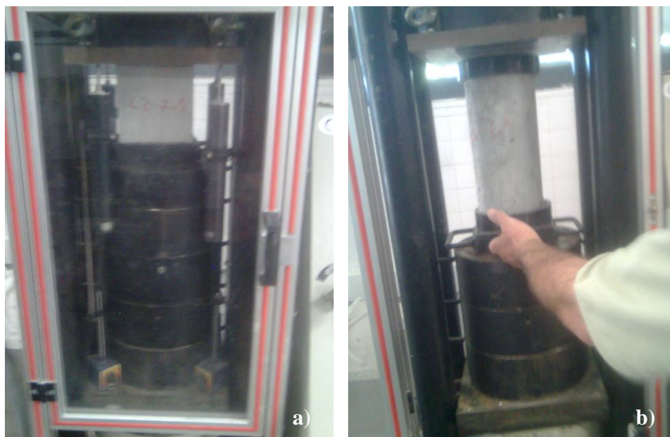
Figura 3.4 – a) cubo com os blocos espaçadores
