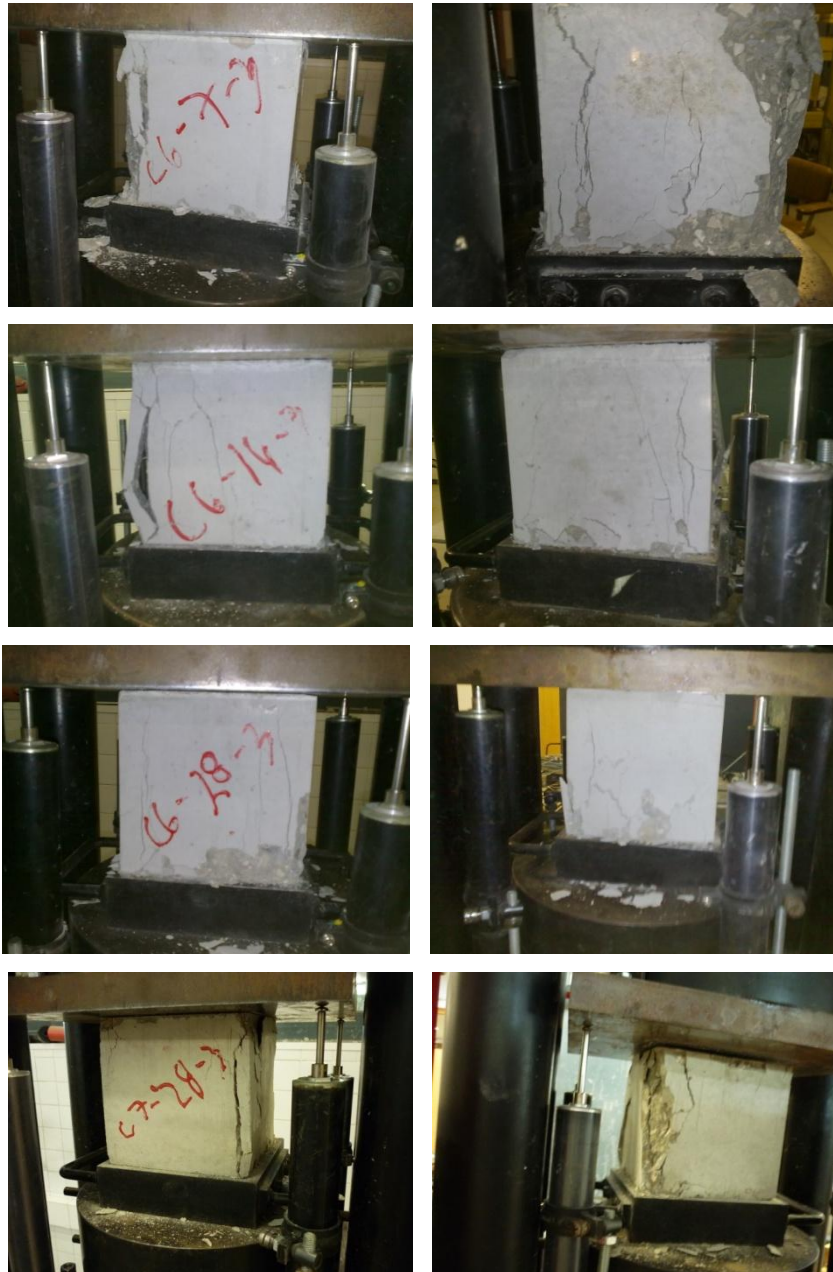
Figura 4.8 – Roturas não satisfatórias obtidas em provetes cúbicos
