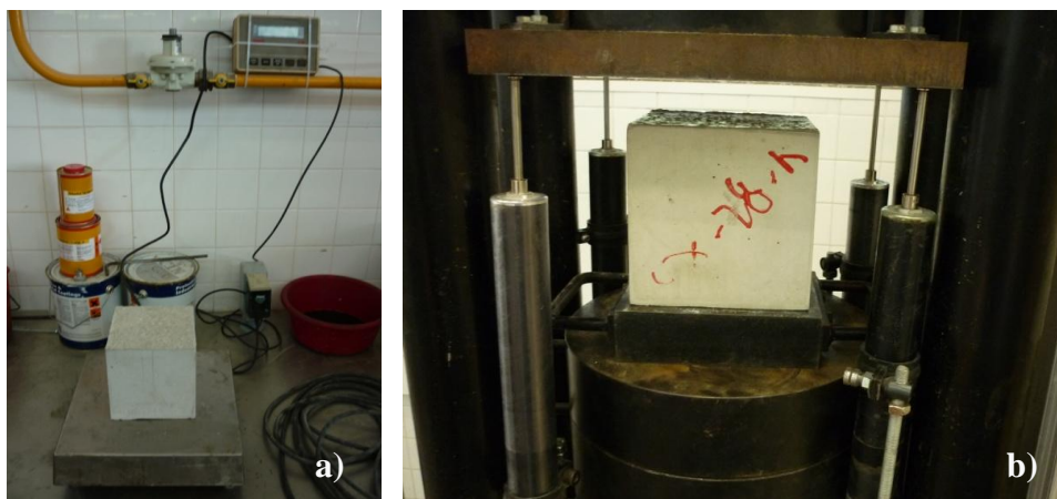
Figura 3.2 – a) Pesagem das amostras b) Amostra na prensa com os deflectómetros
