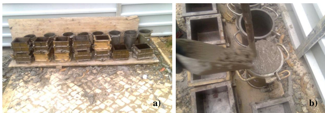
Figura 3.1 – a) Moldes dos cubos e cilindros b) Enchimento e vibração
