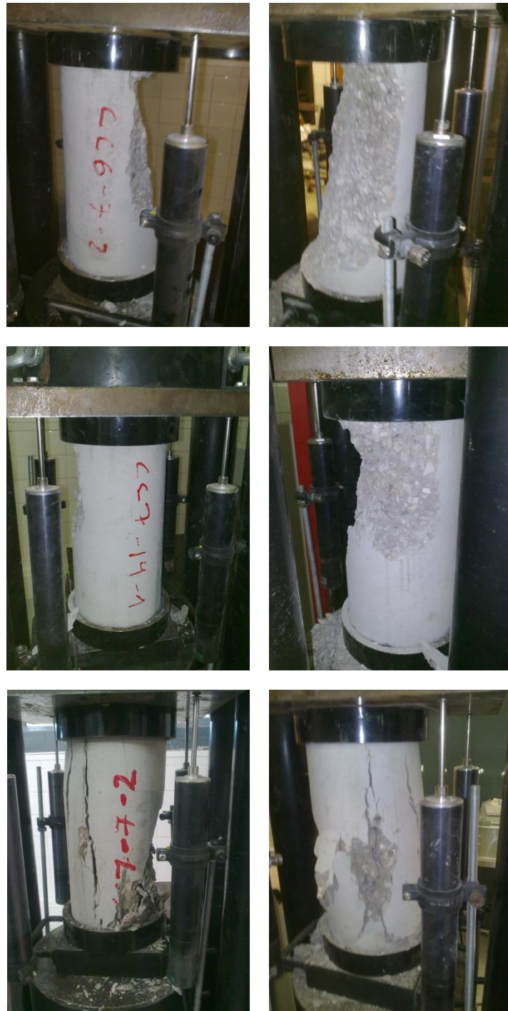
Figura 4.9 – Roturas não satisfatórias obtidas em provetes cilíndricos
