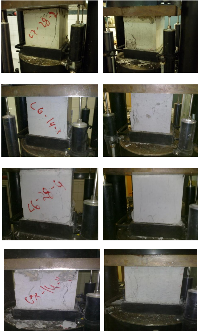
Figura 4.6 – Roturas satisfatórias obtidas em provetes cúbicos
