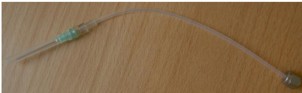
Figura 4. 1 – Sistema agulha, tubo de Teflon® e nut utilizado para fazer a introdução da amostra no analisador. Imagem obtida no laboratório.
