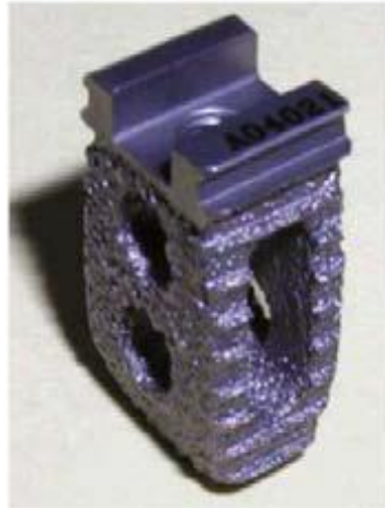
Figura 2.18. – Protótipo de um dispositivo RF , projectado utilizando optimização topológica. Imagem extraída de Zhang et al. 2008.
