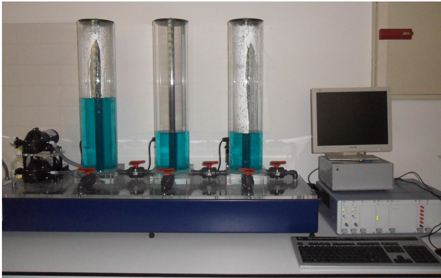
Figura 8.1: Sistema de três tanques.
