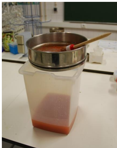
Figura 6.8 – Peneiração por via húmida.
