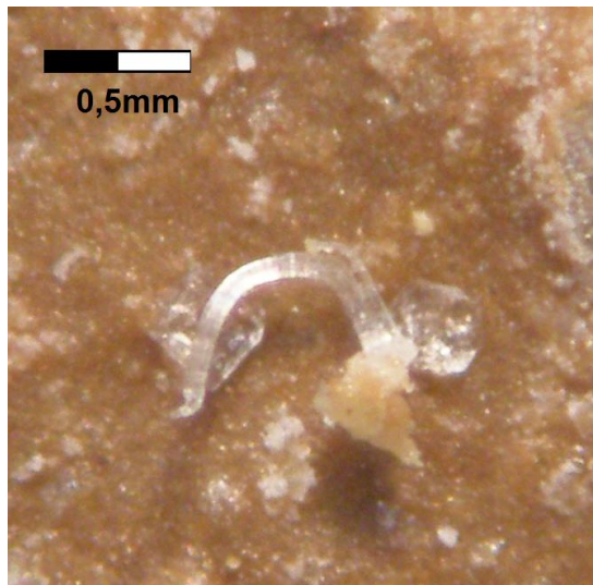
Figura 7.17 – Filamento de halite que provocou escamação.
