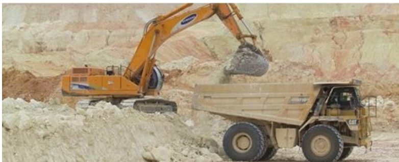
Figura 3.17 – Pá carregadora a carregar dumper ( http://www.thielekaolin.com/ ).
