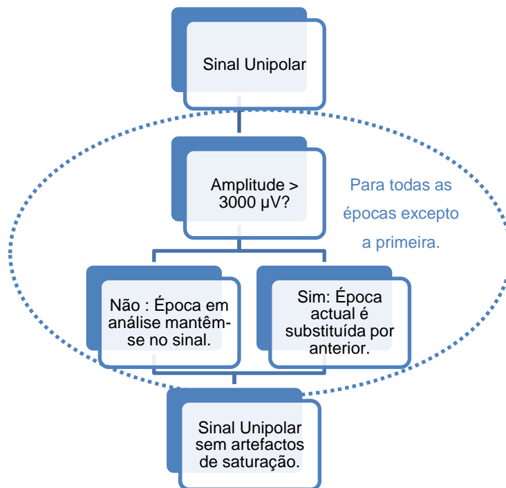
Figura 2-7- Tratamento das épocas (excepto a primeira) em que se analisa se a amplitude do sinal unipolar é superior a 3000 µV.
