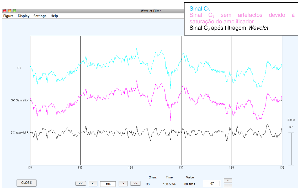
Figura 2-12- Sinal EEG após remoção de artefactos pelo filtro Wavelet passa banda com frequências de corte standard 2 e 30 Hz.
