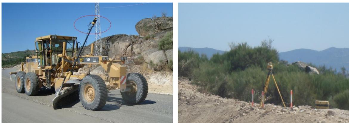
Figura 4.4 - Motoniveladora com sistema de controlo topográfico
