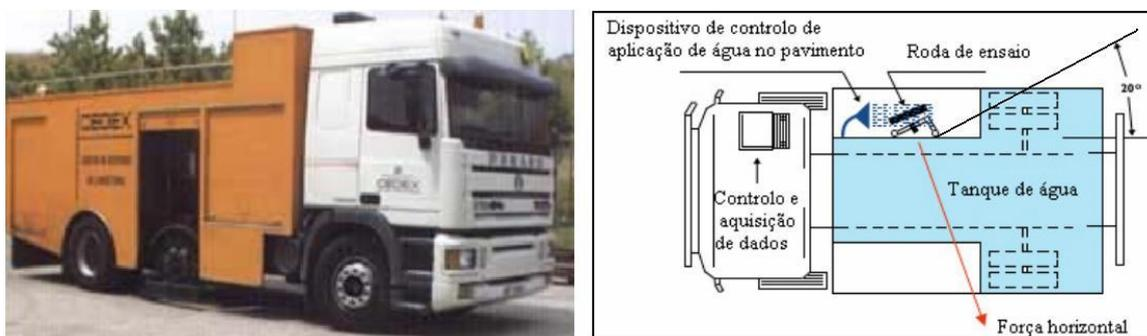
Figura 4.14 - Equipamento SCRIM (à esq.) e esquema do seu funcionamento (à dir.) (adaptado de Alves, 2007)
