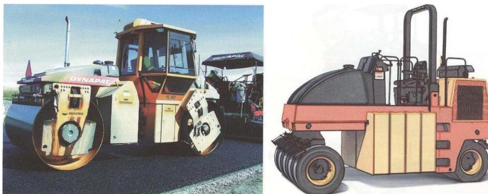
Figura 2.18 - Cilindro de rolos e cilindro de pneus utilizados na compactação (SHELL, 2003)
