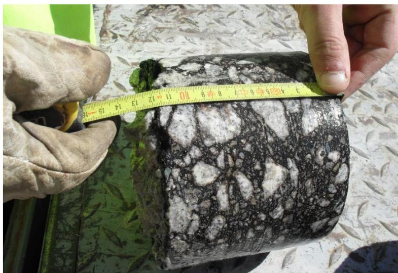
Figura 4.6 - Verificação da espessura de um carote
