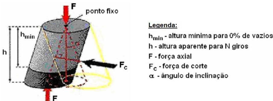
Figura 2.13 - Esquema de funcionamento da prensa de corte giratória (Baptista, 2006)
