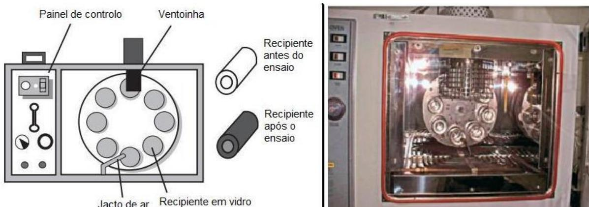
Figura 2.5 - Esquema e exemplo do RTFOT (adaptado de Bernucci, et al., 2006)
