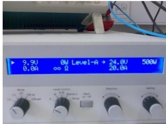
Figura 5.31 – Tensão de saída e potência mostrada pela carga electrónica a 9 cm.
