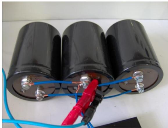
**Figura 5.24 – Condensadores de filtragem do secundário do transformador do sistema ICPT.**
