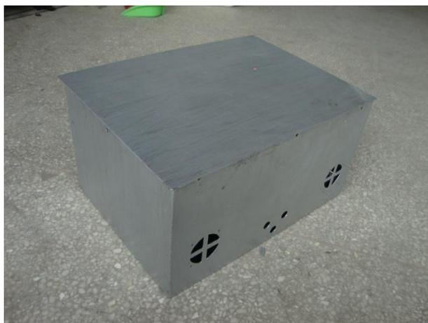
**Figura 2.3 – Caixa da Heter Electronic Group Co., Lda. onde seria montado o conjunto de células para corresponder à configuração desejada.**
