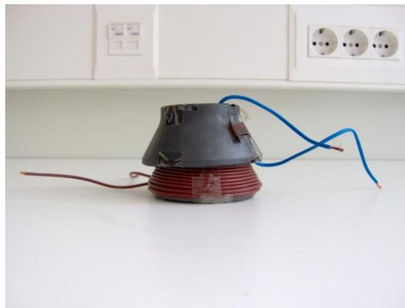
**Figura 5.36 – O visível mau encaixe da solução em forma de cone.**
