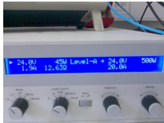
Figura 5.26 – Tensão de saída e potência mostrada pela carga electrónica a 0 cm.
