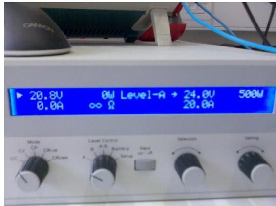
Figura 5.33 – Tensão de saída e potência mostrada pela carga electrónica a 30 cm.
