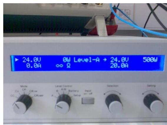
Figura 5.28 – Tensão de saída e potência mostrada pela carga electrónica a 3 cm.
