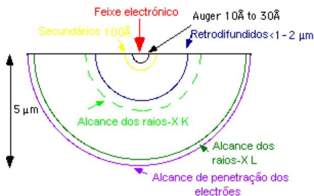
Figura 7-9 Profundidade da origem dos vários tipos de resultados das interações para um feixe acelerado com 20 KV e uma amostra de Ni.
