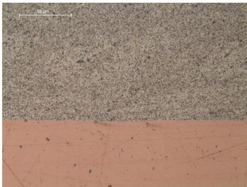
Figura 2-17 Interface maioritariamente mecânica de cobre puro/compósito de matriz de prata onde não se vislumbra qualquer região de interdifusão. Imagem obtida com MO Leica do DCM.
