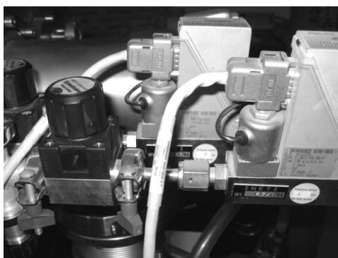
Figura 3.1 – Mass Flow Controllers equipados no sistema de sputtering utilizado.
