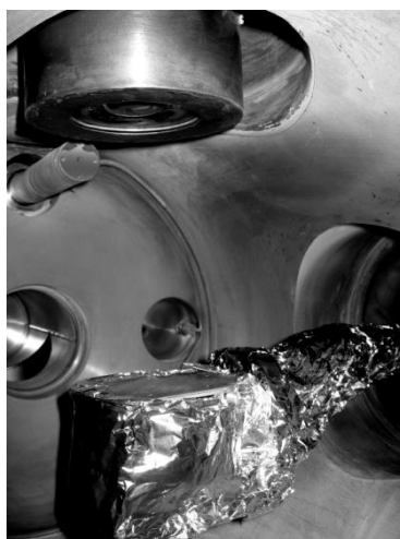
Figura 3.3 – Alvo de pulverização (cima) e porta amostras (em baixo).
