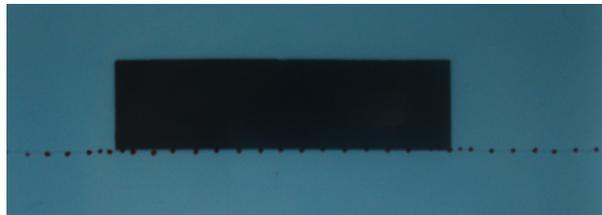
Figura C.6: Radiografia do campo para a qualidade de radiação de referência RQT9. Tempo de exposição igual a 5s e corrente na ampola de 2mA. Colimador de fenda rectangular com uma abertura de 7,5cm.
