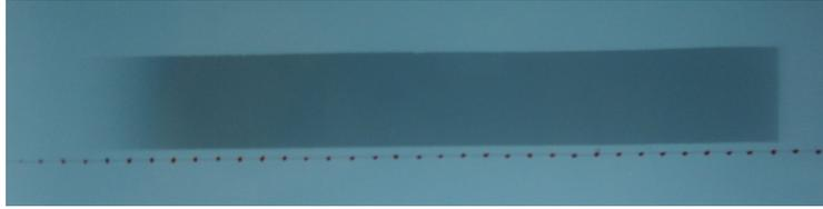
Figura C.5: Radiografia do campo para a qualidade de radiação de referência RQT9. Tempo de exposição igual a 3s e corrente na ampola de 1mA. Colimador de fenda rectangular totalmente aberta.
