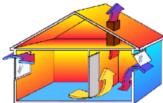
Fig. 3.5 - Mecanismo de transferência de calor por convecção [37]
