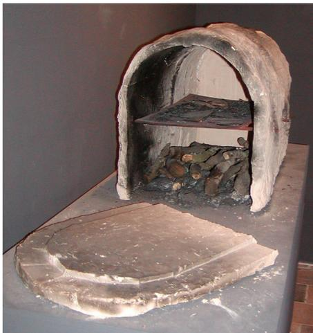
**Fig. 3.2** – Forno para recozimento de vidro, segundo Theophilus (modelo existente no *Centre International du Vitrail*, Chartres, França).
