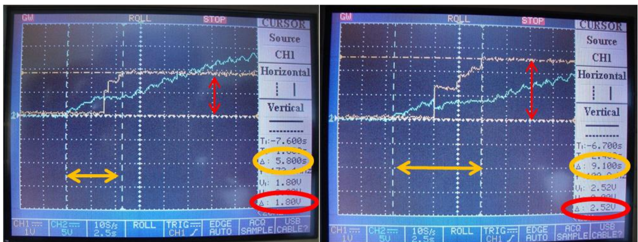
Figura 4.20 Sinal de saída do circuito, a) 1.8V, b) 2.5V
