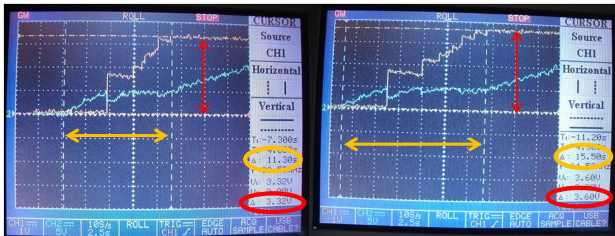
Figura 4.21 Sinal de saída do circuito, c) 3.3V, d) 3.6V
