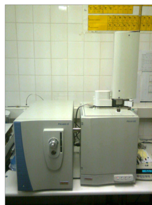
Figura A.12. Cromatógrafo gasoso Focus equipado com espectrómetro de massa Polaris Q (Thermo Electron Corp.).
