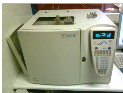
Figura A.11. Cromatógrafo gasoso Trace 2000 series equipado com detector de ionização de chama (ThermoQuest Corp.).
