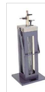
Figura A.6. Densímetro de gases Schilling (Norma IP 59 - Método C).
