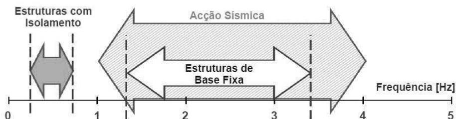
Figura 3.30: Frequências mais comuns de uma excitação sísmica de elevada magnitude, e frequências de uma estrutura pré e pós isolamento. Fonte [36].
