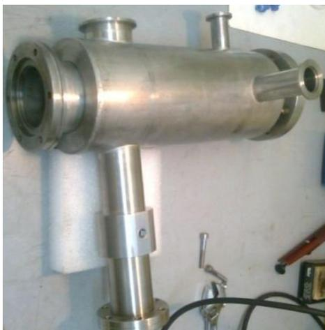
**Figura 4.14:** Sistema visor/medidor de intensidade de feixe antes de ser montado na linha de Reacções Nucleares/PIGE.
