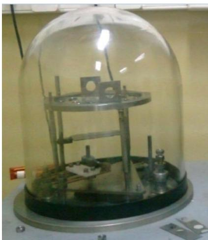
**Figura 4.17:** Evaporadora do UFA-LFI/ITN.
