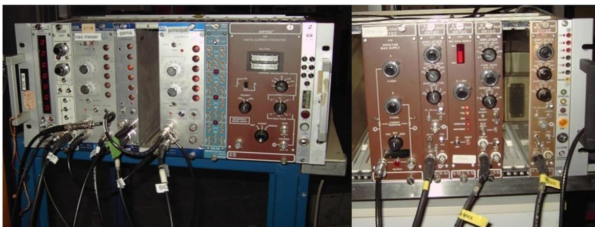
**Figura 4.11:** Electrónica do sistema de detecção de radiação gama e de partículas carregadas utilizado nesta experiência.
