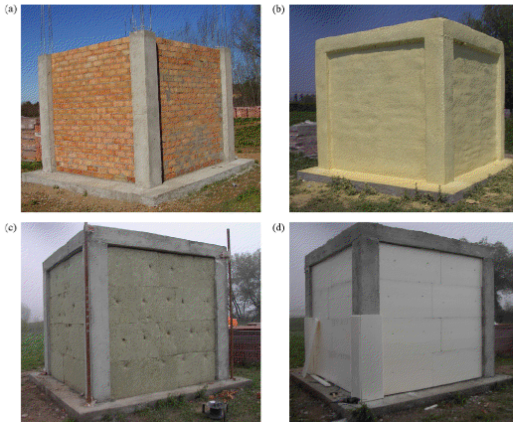
Figura 5 – Cubos analisados. a) Cubo de referência; b) Cubo isolado com poliuretano; c) Cubo com isolamento de lã mineral; d) cubo com isolado com XPS; fonte: Cabeza et al, 2009.
