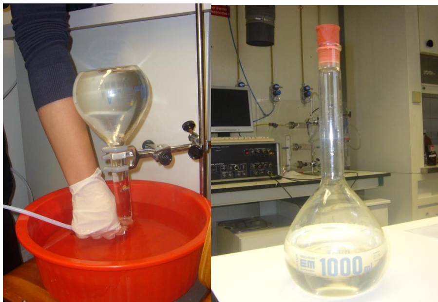
Figura 3.8 – Recolha do gás e balão com os produtos gasosos recolhidos
