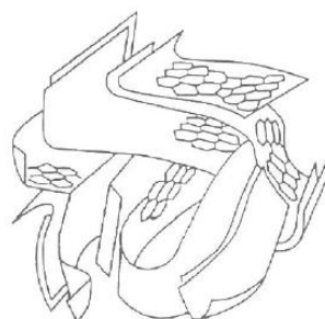
Figura 2.17 – Representação esquemática da estrutura de carvões activados [50]
