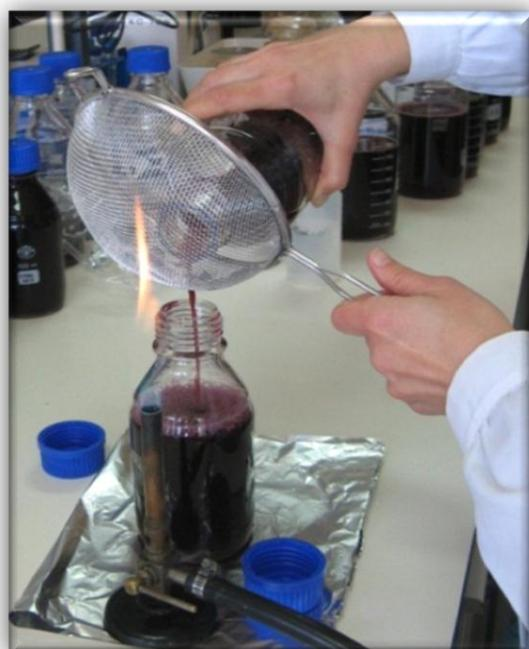
Figura 2.5: Transferência dos fermentados para frascos esterilizados.
