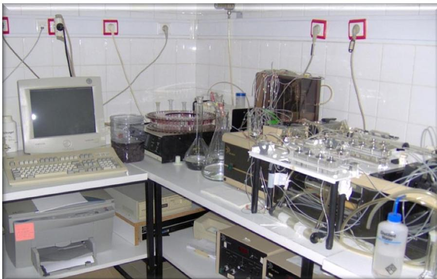
Figura 2.7: Determinação de parâmetros como os açúcares redutores dos fermentados por fluxo contínuo segmentado.
