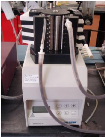
**Figura 2.6** – Bomba de recirculação do Nitrificado, marca Gilson, modelo Minipulse 3
