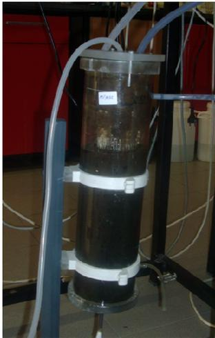
**Figura 2.4** - Sistema de filtração por membranas.
