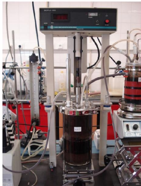
**Figura 2.3** - Reactor aeróbio.
