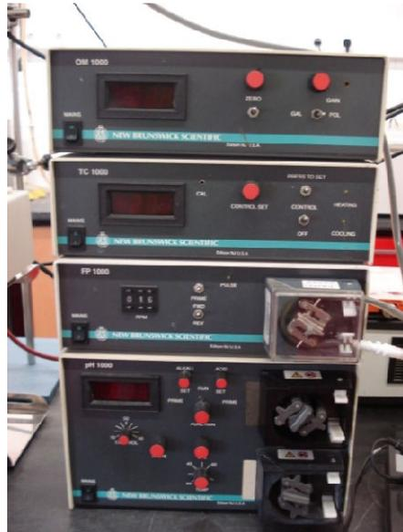
**Figura 2.10** – Bomba de adição do Centrifugado e sistema de controlo da temperatura do reactor anóxico, marca Edison NJ, modelos FP1000 e TC1000, respectivamente.
