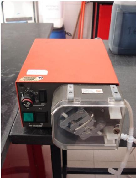
**Figura 2.11** – Bomba de retirada do Permeado, marca Watson-Marlow, modelo 302 S.
