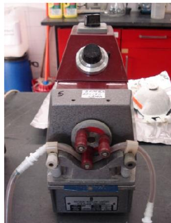
**Figura 2.7** – Bomba de recirculação das Lamas, marca Watson Marlow, modelo MHRE 22.
