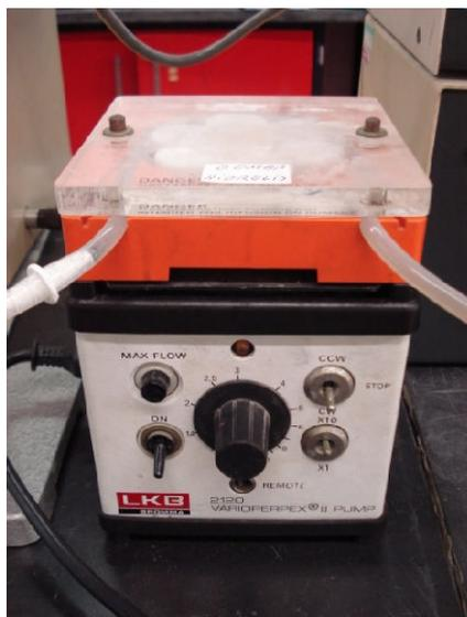
**Figura 2.9** – Bomba de adição de Hidrolisado, marca LKB Bromma, modelo Varioperpex® Pump 2120.
