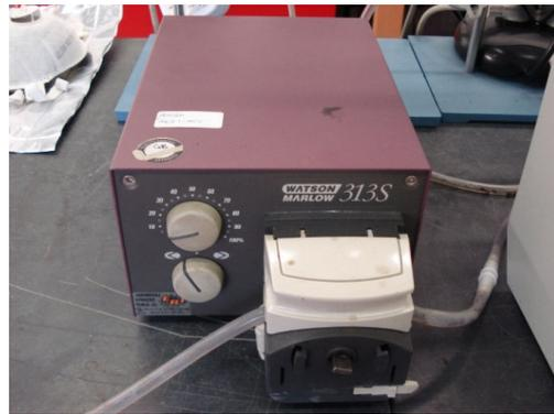
**Figura 2.5** – Bomba de retirada do Nitrificado, marca Watson Marlow, modelo 313 S.
