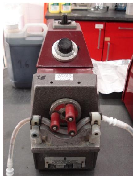
**Figura 2.12** – Bomba de retirada das Lamas, marca Watson Marlow, modelo MHRE 200.
