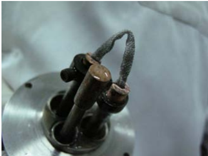
Figura 4.16: Filamento feito de malha de platina e limpo por ácido. Figura 4.17: Filamento com cloreto bórico aquecido com um maçarico.
