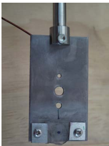
Figura 4.18: Pormenor da chapa de Ta do sistema de colimadores e quartzo da linha de Reacções Nucleares do acelerador Tandem. A chapa de Ta tem furos com 3 diâmetros diferentes (2, 5 e 3 mm).
