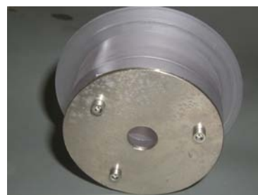
Figura 4.23: Pormenor da chapa de Ni que protege o colimador da câmara de Reacções Nucleares do acelerador Tandem.
