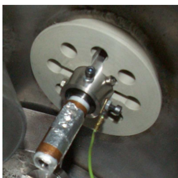
Figura 4.8: Extensão do sistema de colimadores vista dentro da câmara de Reacções Nucleares.
