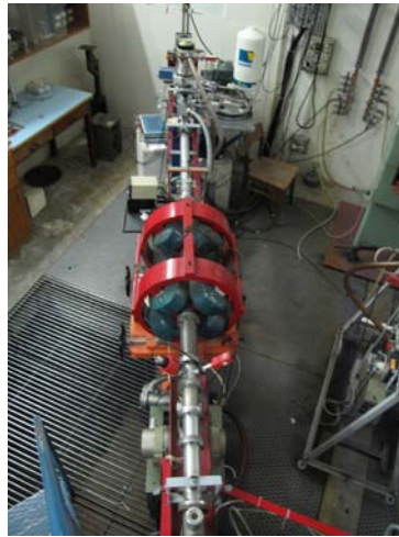
Figura 4.13: Linha de reacções Nucleares de PIXE do acelerador Van de Graaff sem a câmara de Reacções Nucleares.
