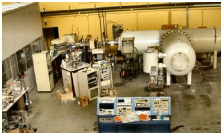
Figura 4.12: Acelerador Tandem de 3 MV do Instituto Tecnológico e Nuclear (UFA-ITN).
