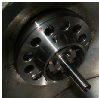
Figura 4.7: Fotografia do beam stopper da câmara de Reacções Nucleares.
