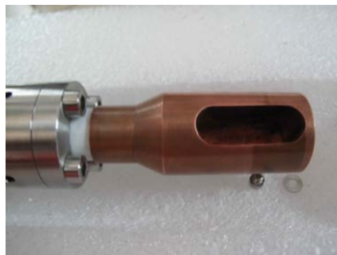
Figura 4.21: Faraday Cup em Cu isolada com mac-cord da linha de Reacções Nucleares do acelerador Tandem.
