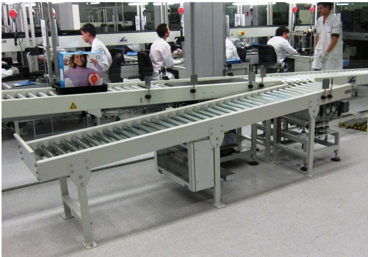
Figura 7.4 – Aspecto geral da Solução para Verificação de Peso e Retorno de Caixas Não Conformes para correção.
