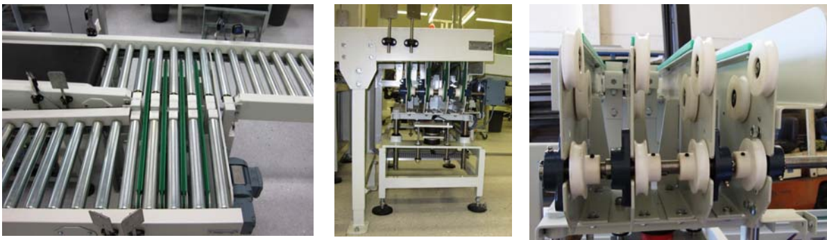
Figura 7.7 – Sistema de Transferência Lateral de caixas não conformes.
