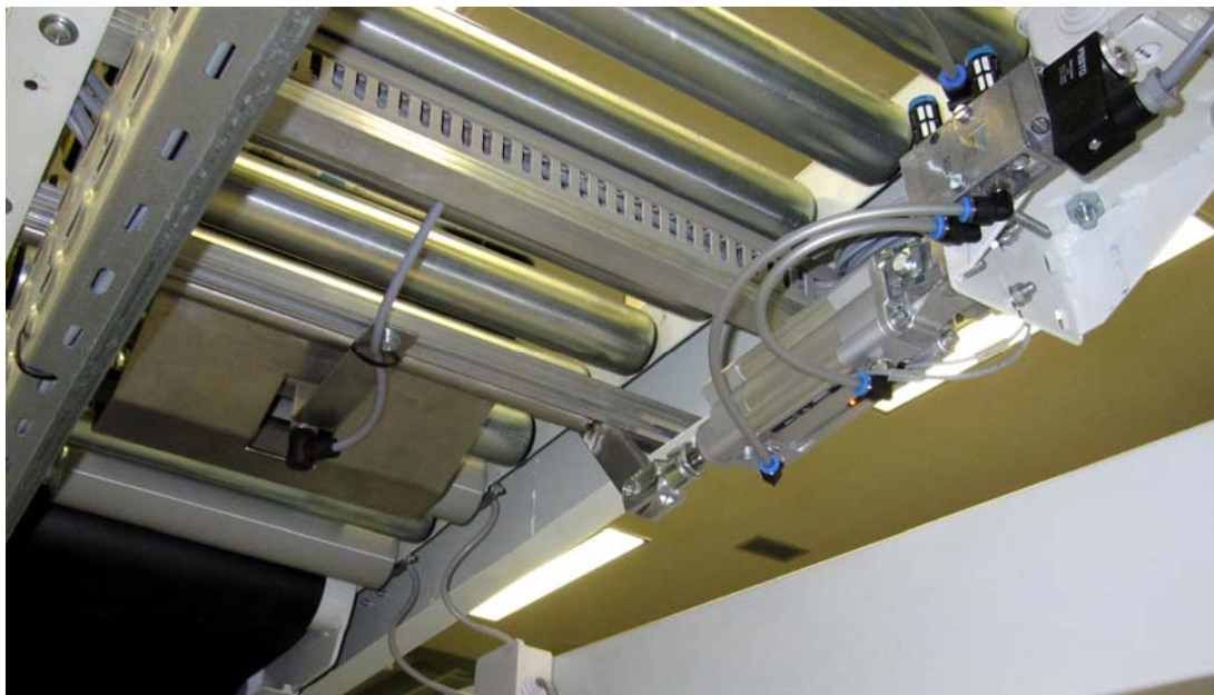
Figura 7.11 – Fotografias do Cilindro Pneumático que actua o Batente Retráctil.
