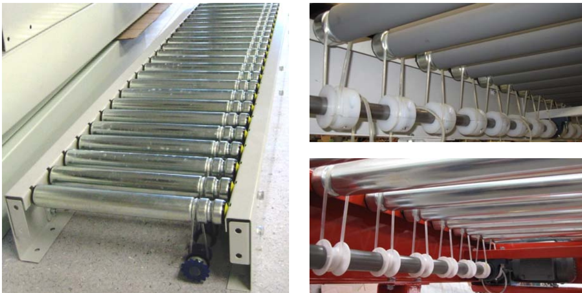
Figura 7.19 – Exemplo de Transportadores de Rolos Motorizados com transmissão de movimento através de polias e correias, a partir de um veio longitudinal.
