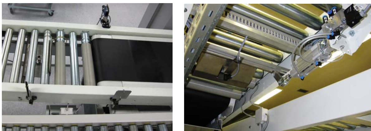
Figura 7.5 – Sistema de Separação e Espaçamento de caixas.
