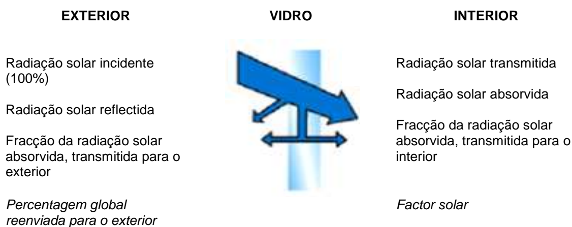
Figura 3 – Decomposição do fluxo incidente num vão envidraçado
