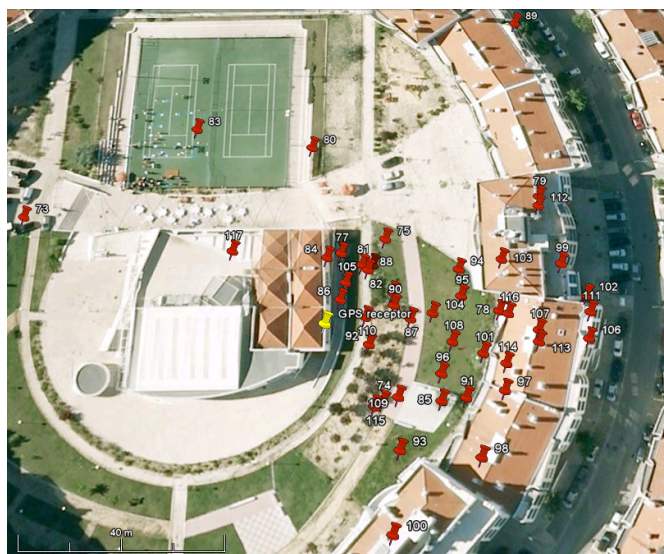
Figura 4.1: Ilustração de má receção do GPS. Pontos captados (marcadores vermelhos 74-116) com o receptor GPS estático (marcador amarelo).
