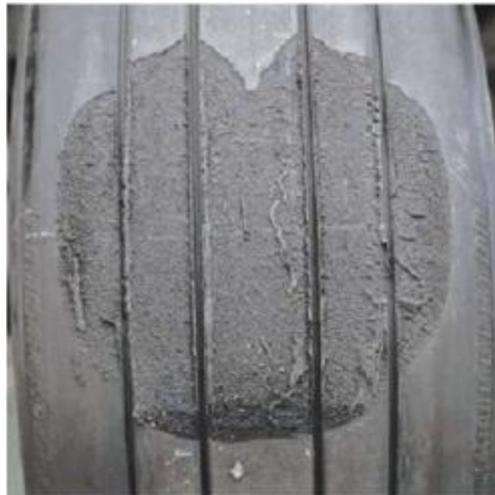
Figura 2.5 - Zona de contacto de um pneu aeronáutico que sofreu hidroplanagem por desvulcanização (Filho, 2006).
