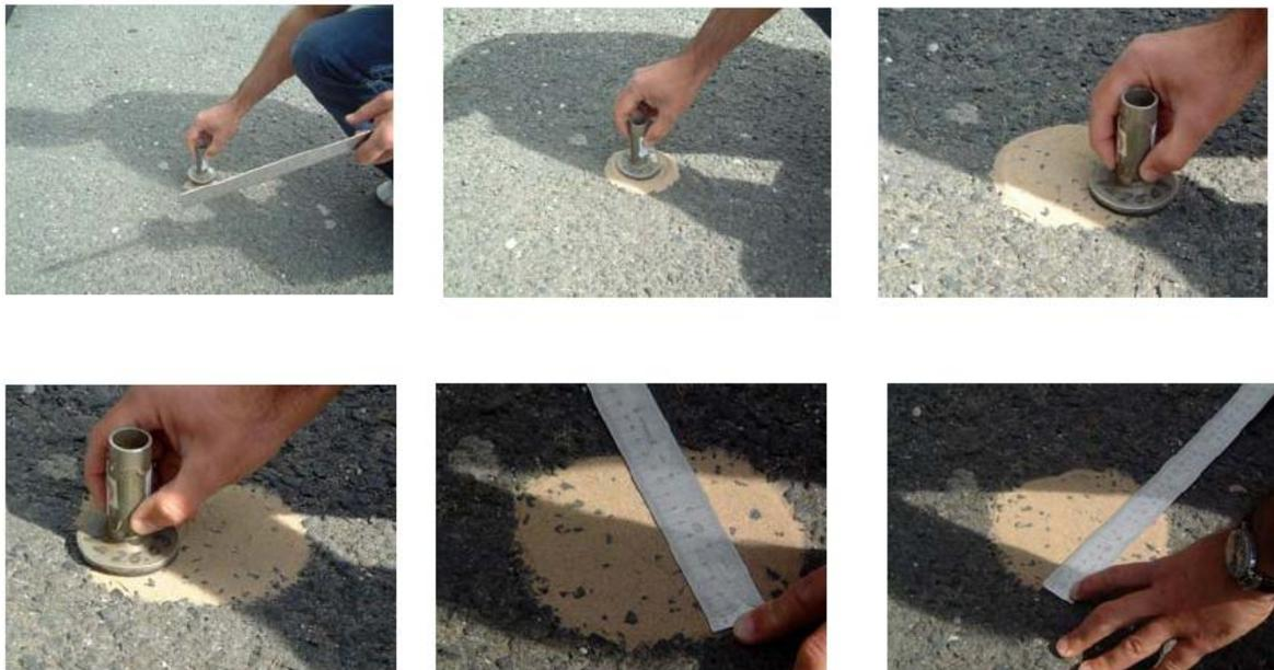
Figura 2.35 - Sequência da técnica do ensaio da mancha de areia normalizada (Alves, 2007).
