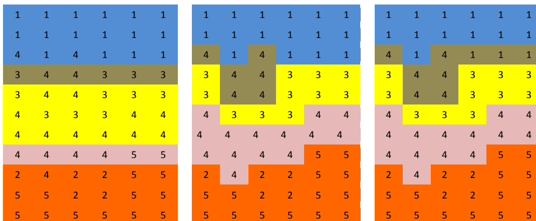
Figura 5.24 - Exemplo da construção dos limites entre unidades: 1) unidades de partida; 2) resultado final após método de otimização; 3) pós-processamento
